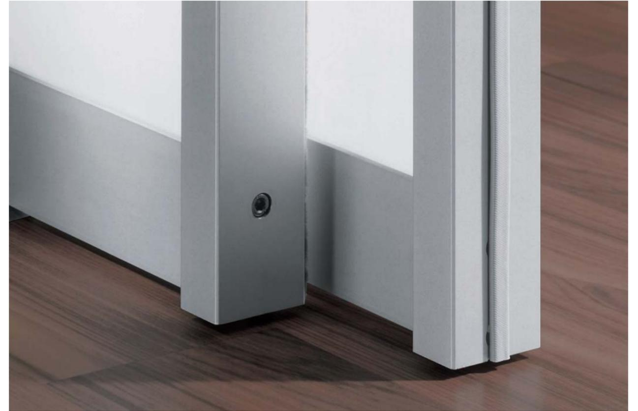
SINUS Hängende Türen werden über Laufwerke in der Deckenschiene bewegt. Ein im Fußboden verbodrter Führungsstift verhindert das Schwingen der Tür. Dadurch kann auf sichtbare Bodenschienen verzichtet werden.
